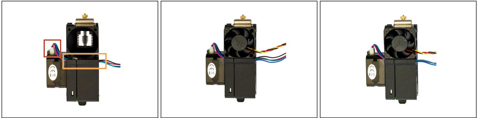
**⚠** Vergrößern Sie am Sunon Fan die vier Schraubenlöcher mit einem Senker und entfernen Sie die Kabelführung.
