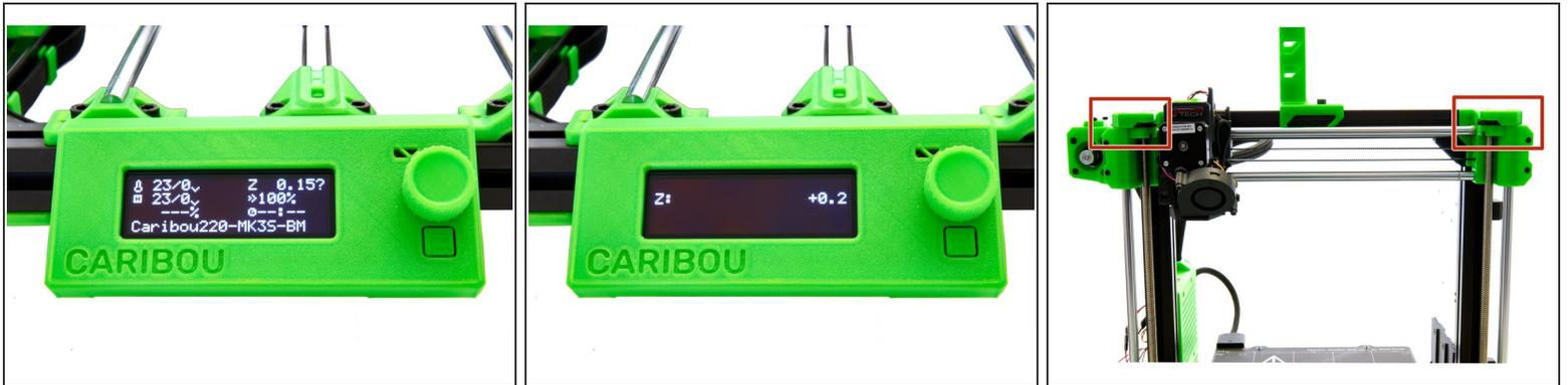
**i** Durch Drehen des Drehknopfs am Display kann zwischen den Einträgen gewechselt werden und durch einmaliges Drücken werden einzelne Einträge ausgewählt.
