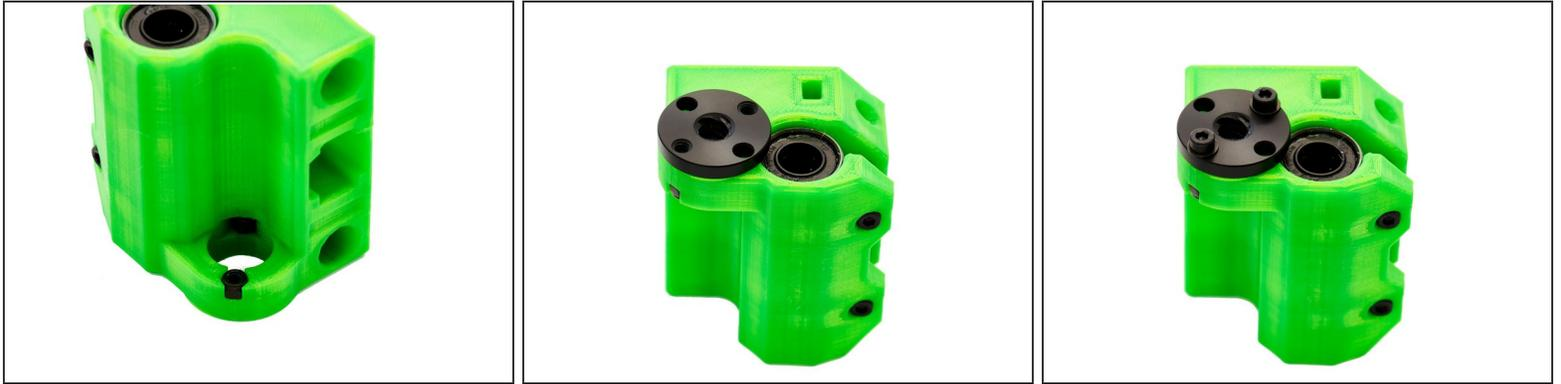
**⚠** Überprüfen Sie das Loch für die POM Mutter auf Filamentüberstände und entfernen Sie diese gegebenenfalls mit einem Messer, wie z.B. einem Skalpell.
