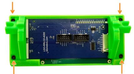
**i** Entfernen Sie zuerst die Schutzfolie vom Display, da sie bei einem bereits zusammengebauten Display nicht mehr entfernt werden kann.
