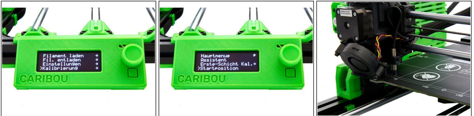
**⚠** Bevor Sie fortfahren, stellen Sie sicher, dass der Pinda sich auf einer Höhe mit oder etwas tiefer als die Düse befindet.
